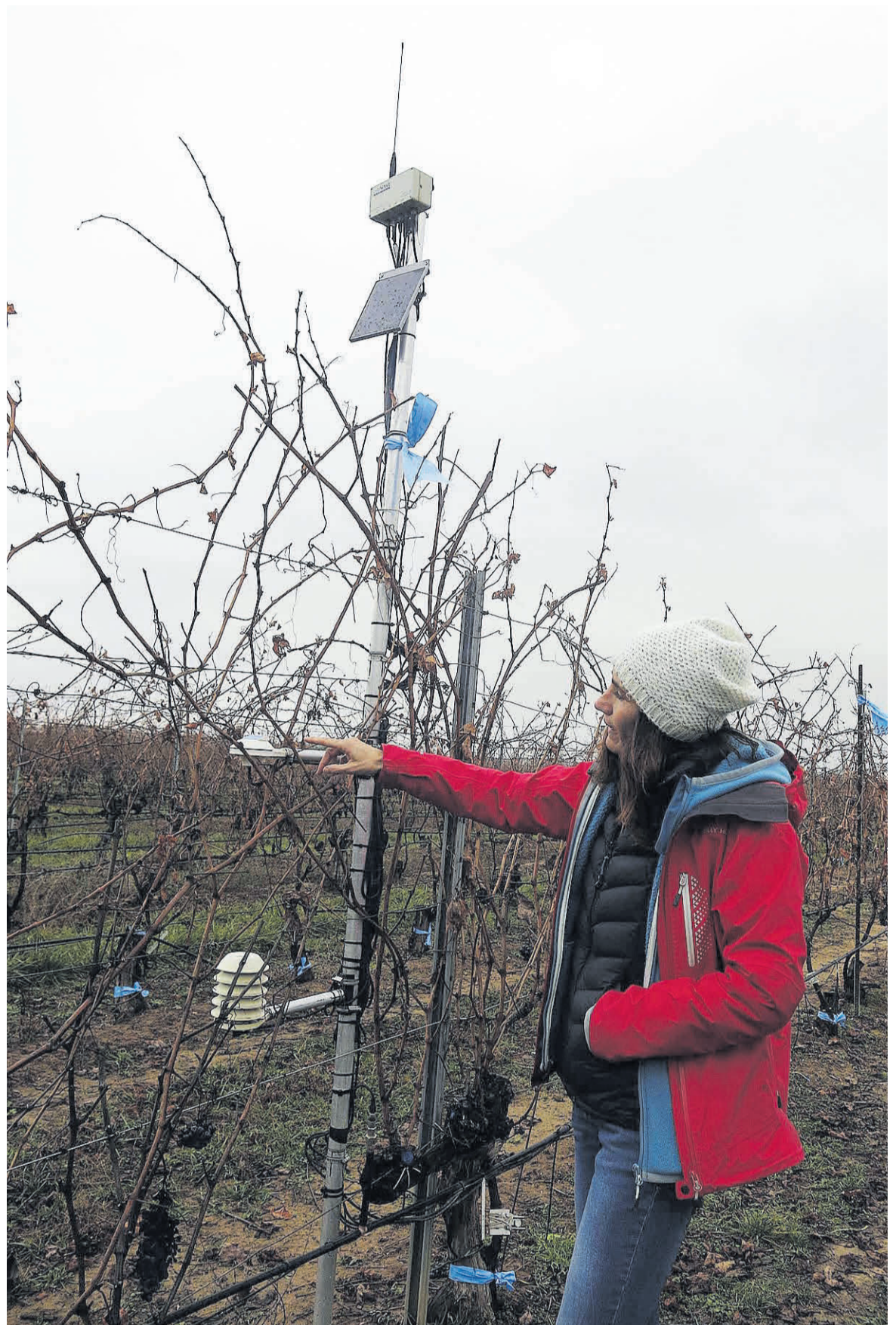
En el terreno hay colocados sensores tanto de clima como de suelo y de las cepas para registrar múltiples parámetros. / FOTOS: DB
